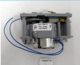
Ajoitin Elektrobar 20min E50
