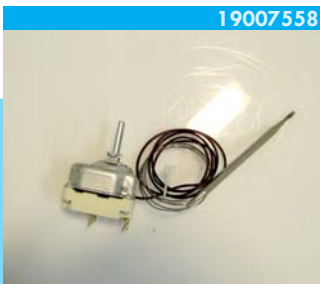
Termostaatti rasvank.3-vaih.kap 6mm 1470mm 95-185C
