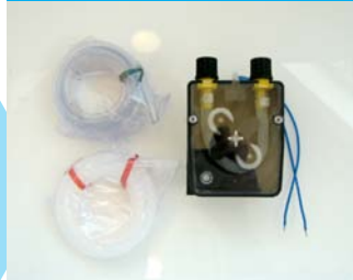
Huuhteluainepumppu Seko PG 0,4 Elux,Zan
